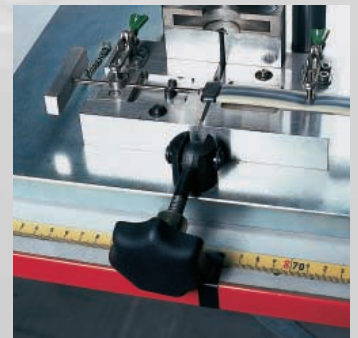
Geöffnetes Anspritzwerkzeug nach der Anspritzung
